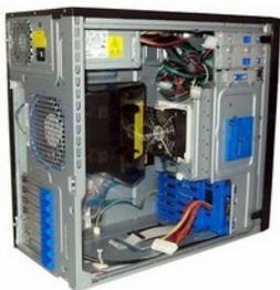
Ogni PC è dotato di un *alimentatore* che può raggiungere un'efficienza dell'80- 90%. Ad esempio se l'alimentatore è da 100 W, ben 10-20 W sono disperse sotto forma di calore.
